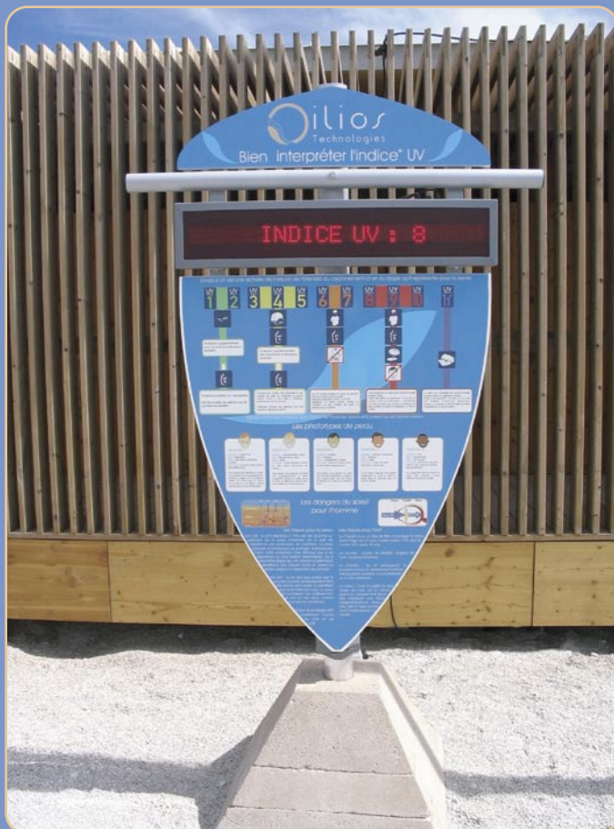
Le Totem "Bouclier", composé d'un afficheur électronique lumineux et d'un panneau informations statique.
