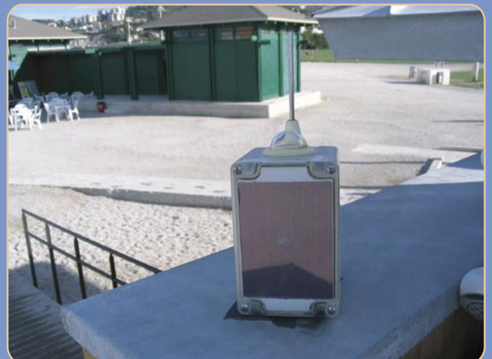
L'appareil de mesure de l'indice UV: l'illiomètre.
